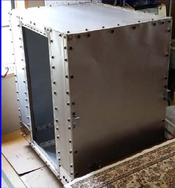
★EMdriveのマグネトロンから漏洩する恐れのあるマイクロ波の外部への放射を遮断する。
