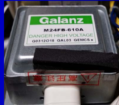
・Magnetron (Galanz 2.45GHz 空冷)
