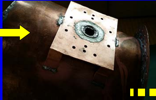
・Magnetron取付座を Cavityにろう付け
