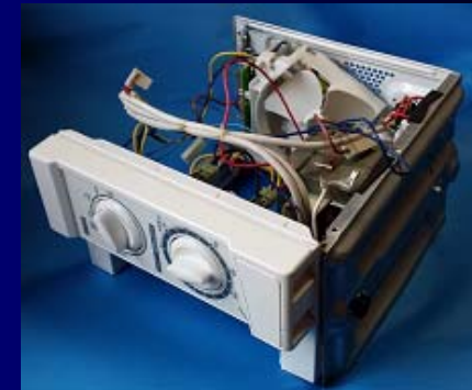
・MicroWave発信器 出力 最大700W
