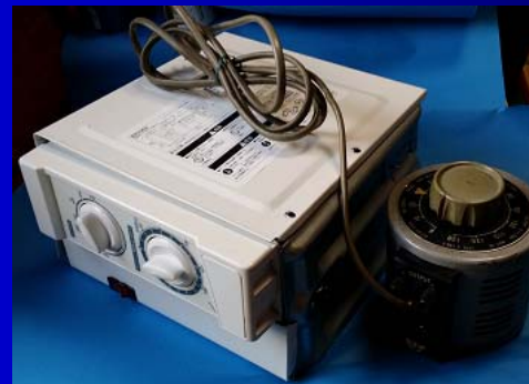
Magnetronのアノード電流を制御しMagnetron出力を可変にする
